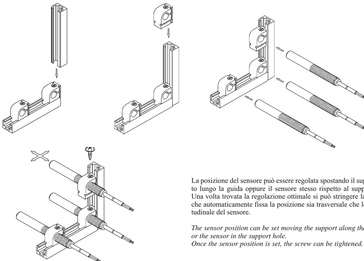
La posizione del sensore può essere regolata spostando il supporto lungo la guida oppure il sensore stesso rispetto al supporto. Una volta trovata la regolazione ottimale si può stringere la vite che automaticamente fissa la posizione sia trasversale che longitudinale del sensore.
