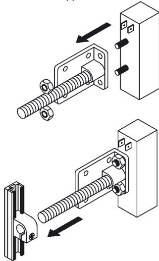
L'assieme sensore-basetta può ora essere inserito all'interno dell'assieme composto da supporto più guida.
