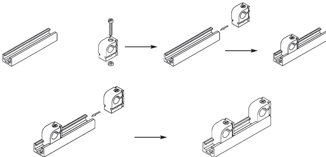
Il sensore può ora essere inserito all'interno dell'insieme composto da supporto più guida. La posizione del sensore può essere regolata spostando il supporto lungo la guida oppure il sensore stesso rispetto al supporto.
